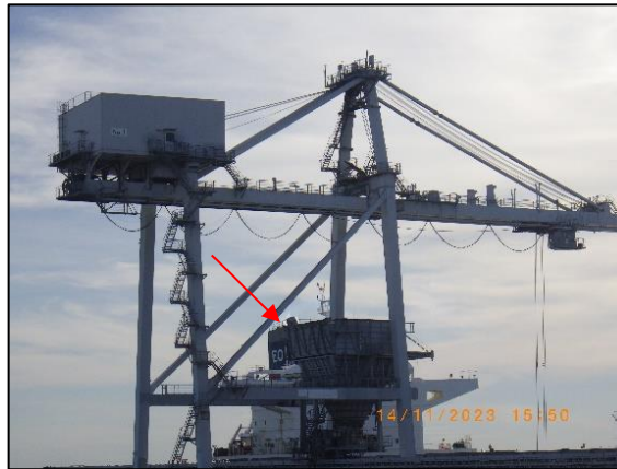
รูปที่ 2-4 แผ่นกำบังลมที่ Ship Unloading Hopper
